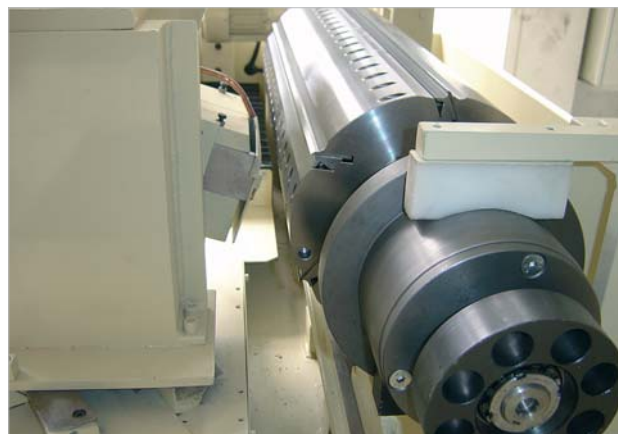
Albero piolla, 670 mm, completo di sistema di supporto e attacco rapido in posizione di affilatura.
