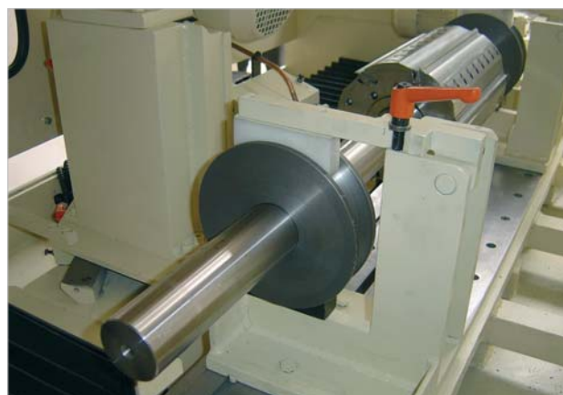
Albero piolla, 670 mm, completo di sistema di supporto e attacco rapido in posizione di affilatura.
