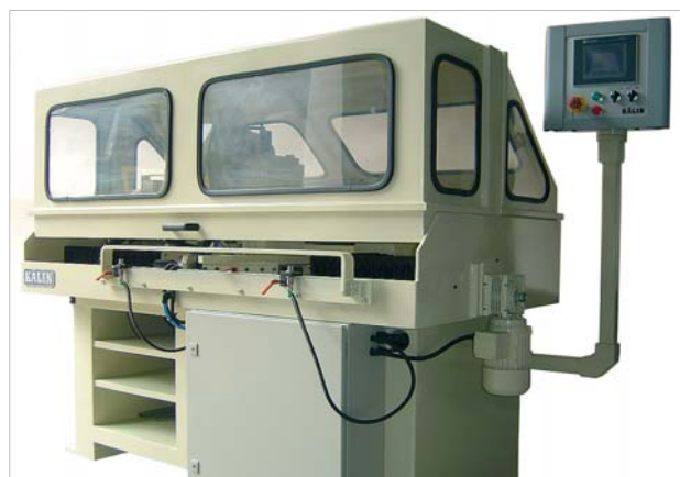
Interruttore di prossimità per limitazione della corsa a seconda della larghezza di lavoro.
